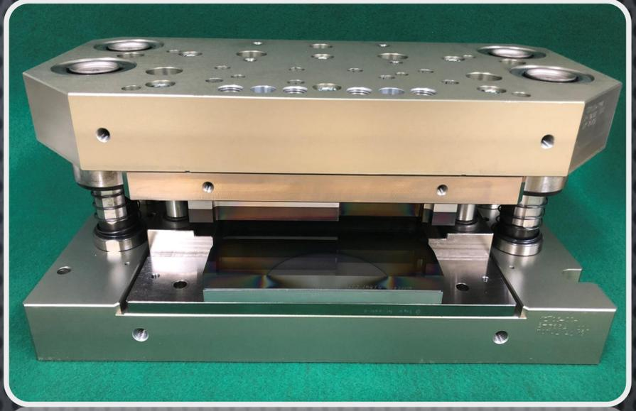
輪郭精度0.001mmの切刃が、極薄箔のクリーンカットを実現
